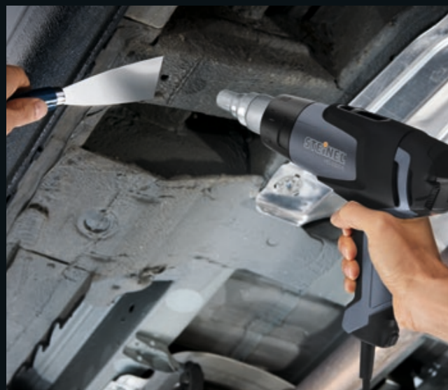
Отстраняване на подова защита
