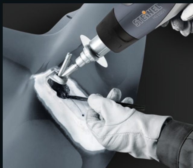
Ремонт на пукнатини в автомобилни брони.
